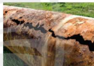
▲ Đường ống dẫn nước bị hư hỏng do sự ăn mòn kim loại
