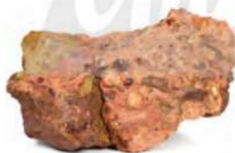
Quặng bauxite (Thành phần chính: \text{Al}_2\text{O}_3 )
