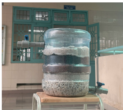
Những bình lọc nước bằng những vật liệu đơn giản được học sinh chế tạo để xử lý nước sinh hoạt
