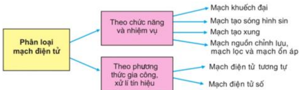
Hình 7 – 1. Sơ đồ phân loại mạch điện tử
