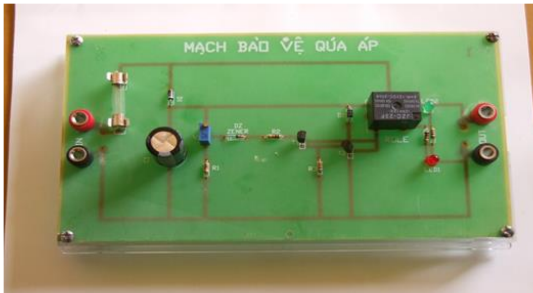
Hình 14 – 3. Sơ đồ mạch báo hiệu và bảo vệ quá điện áp
