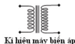
Máy biến áp
