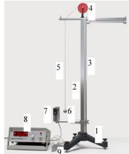
Hình 6.1. Bộ thiết bị thí nghiệm khảo sát dao động của con lắc đơn
