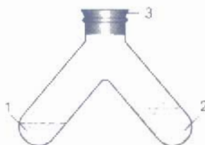
Hình 8.8. Ống nghiệm 2 nhánh dụng nước vôi trong để nhận biết \text{CO}_2 1 – Dung dịch \text{CO}_3^{2-} ; 2 – Nước vôi trong ; 3 – Nút cao su.
