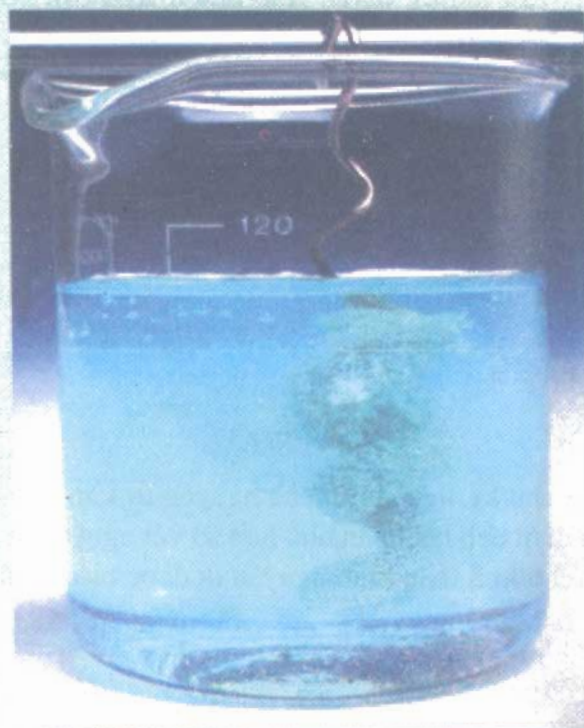
Thí nghiệm Cu khử ion \text{Ag}^+ trong dung dịch \text{AgNO}_3
