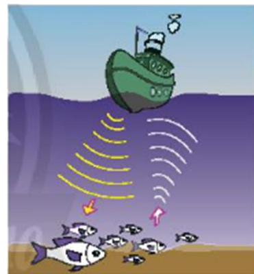
▲ Hình 6P.1. Sử dụng kỹ thuật sonar để phát hiện đàn cá dưới biển
