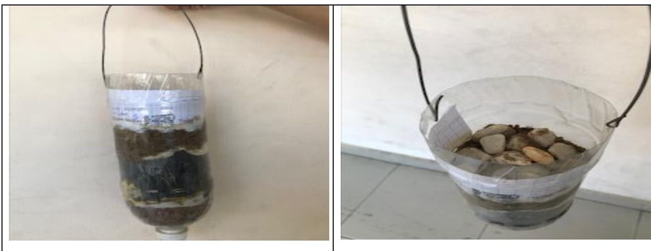
Hệ thống lọc nước từ chai nhựa nước ngọt, cát, than, sỏi ...
