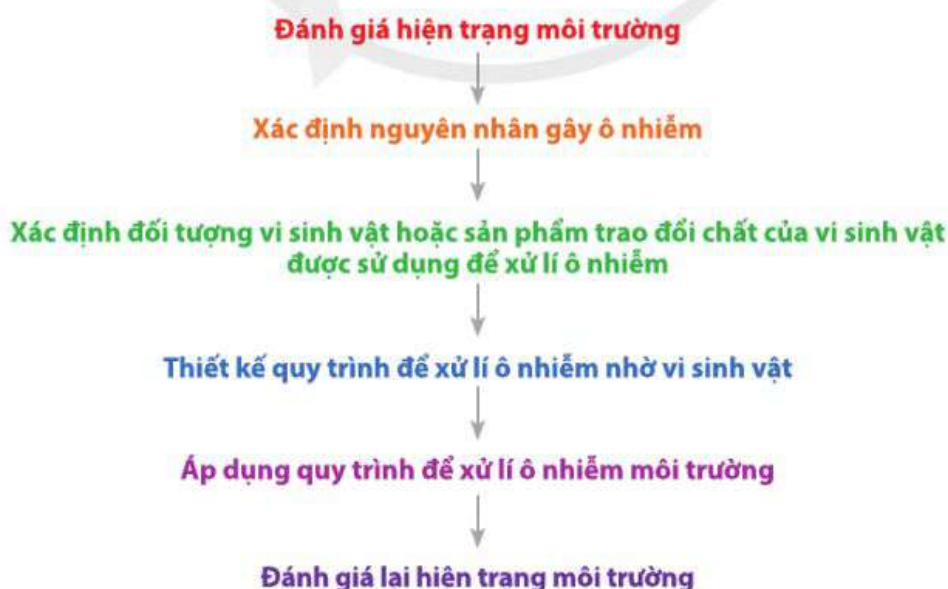
Hình 12.1. Sơ đồ các bước xử lý ô nhiễm môi trường bằng công nghệ vi sinh vật
